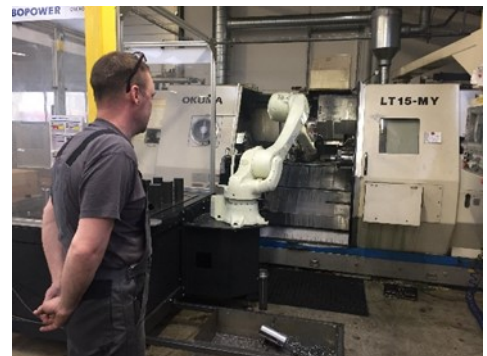
9-akset drejebænk med dobbeltspindel, 2 revolvere med Y-akse og robot-lader
